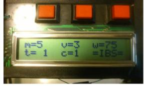
利用磁簧開關做輪圈數的計數,然後將數據傳到 IC 的程式做運算後,可以得到運動者的騎乘距離(公尺)、速度(時速)、時間(分鐘)、消耗的卡路里熱量(卡)。
